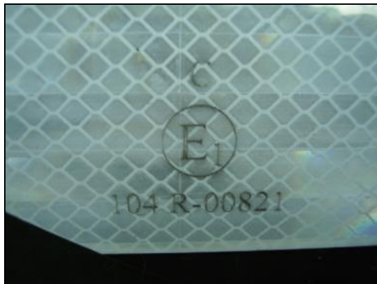
Obr. 4.: Schvaľovacia značka podľa predpisu EHK č. 104 na reflexnom páse bielej farby. Znak „C“ v hornej časti určuje, že ide o pás na vyznačenie obrysov vozidla. Materiál na nepovinné plošné nápisy a grafiku má označenie „D“ (pre použitie na obmedzených plochách) alebo „E“ (pre použitie na veľkých plochách).
