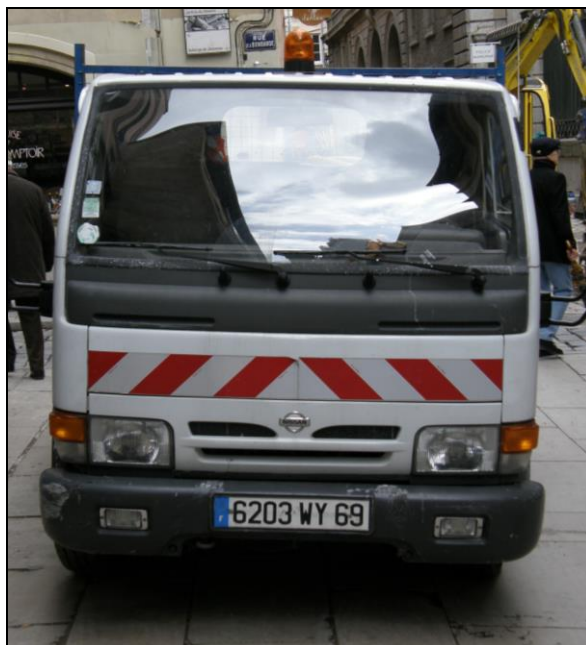
Obr. 16.: Špeciálne označenie vozidla umiestnené na vozidle vykonávajúcom prácu za jazdy – vozidlo správcu pozemnej komunikácie; obdobné označenie musí byť na vozidle umiestnené aj vzadu.
