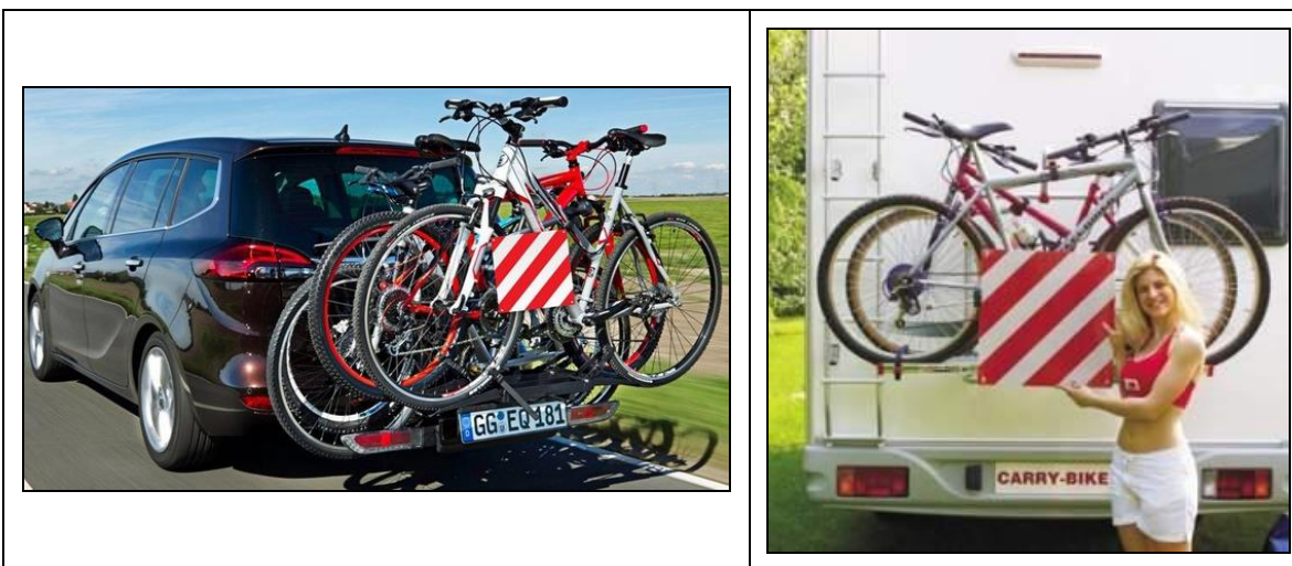
Obr. 27.: Označenie prečnievajúceho nákladu umiestnené na nosiči bicyklov.
