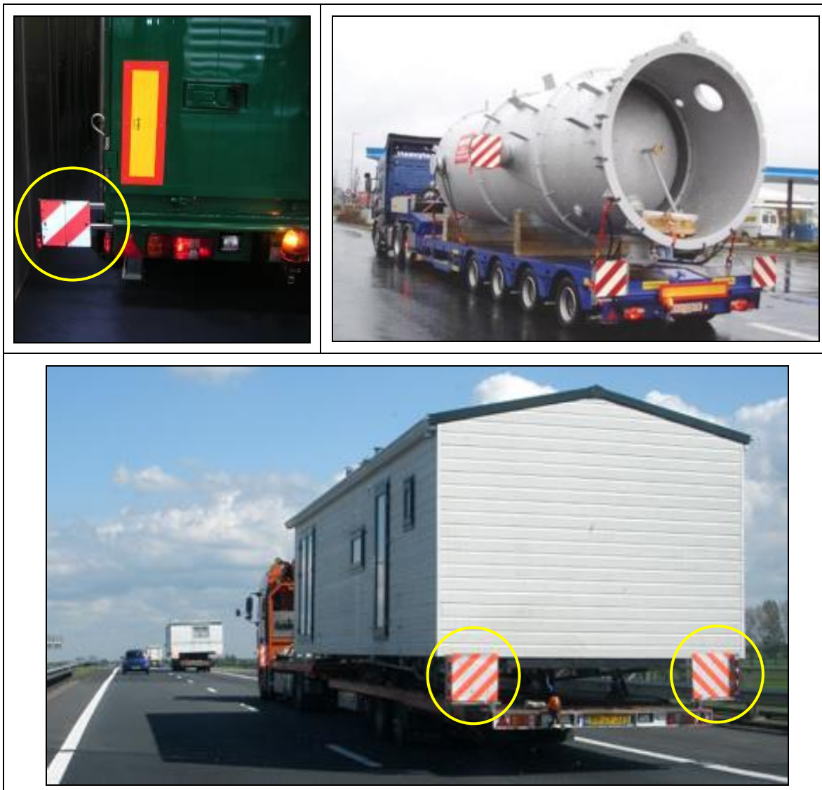
Obr. 14.: Špeciálne označenie vozidla umiestnené na širokom vozidle, obdobné označenie musí byť na vozidle umiestnené aj vpredu po oboch stranách.
