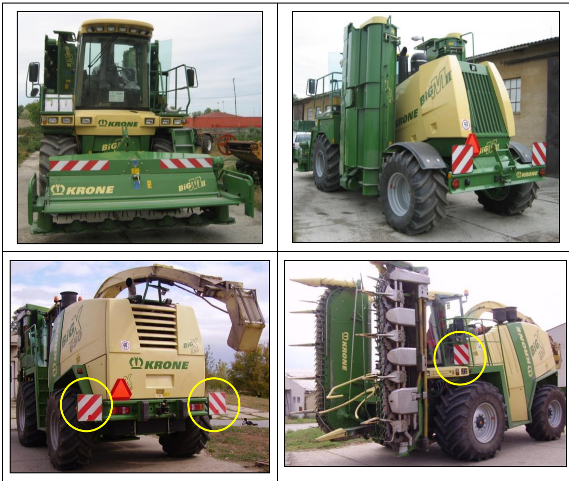
Obr. 18.: Špeciálne označenie vozidla umiestnené na pracovnom stroji samohybnom.
