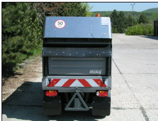
Obr. 15.: Špeciálne označenie vozidla umiestnené na vozidle vykonávajúcom prácu za jazdy – zametacie vozidlo; obdobné označenie musí byť na vozidle umiestnené aj vpredu.
