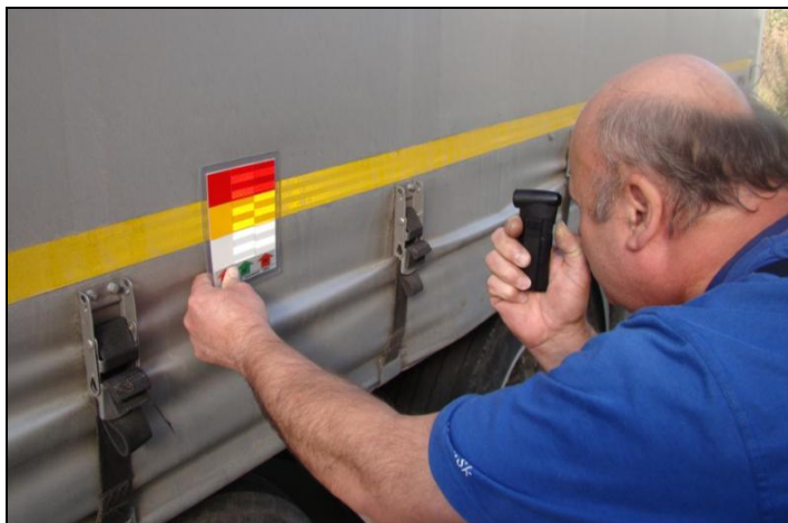
Obr. 33.: Posudzovanie odrazivosti na zvýšenie viditeľnosti a rozoznatel'nosti pomocou etalónu a optického komparátora.
