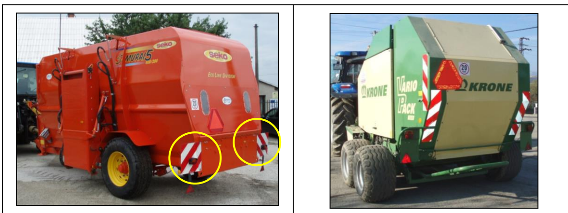
Obr. 19.: Špeciálne označenie vozidla umiestnené na ťahanom vymeniteľnom stroji za traktor vzadu; takéto označenie musí byť na vozidle umiestnené aj vpredu po oboch stranách.
