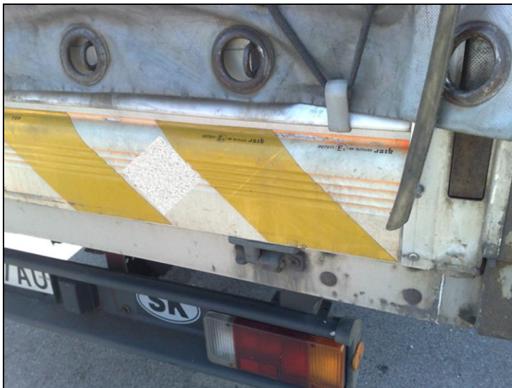
Obr. 34.: Opatrebná zadná označovacia tabuľka ťažkých vozidiel; ak je poškodená natoľko, že už neplní svoju funkciu, považuje sa to pri technickej kontrole za vážnu chybu.
